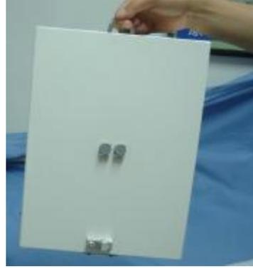
1000MHz 天线可检测不深于 0.6 米的目标，可用于公路路面层厚度的测量等，如图 5 所示。天线尺寸为 225\*102\*114mm
