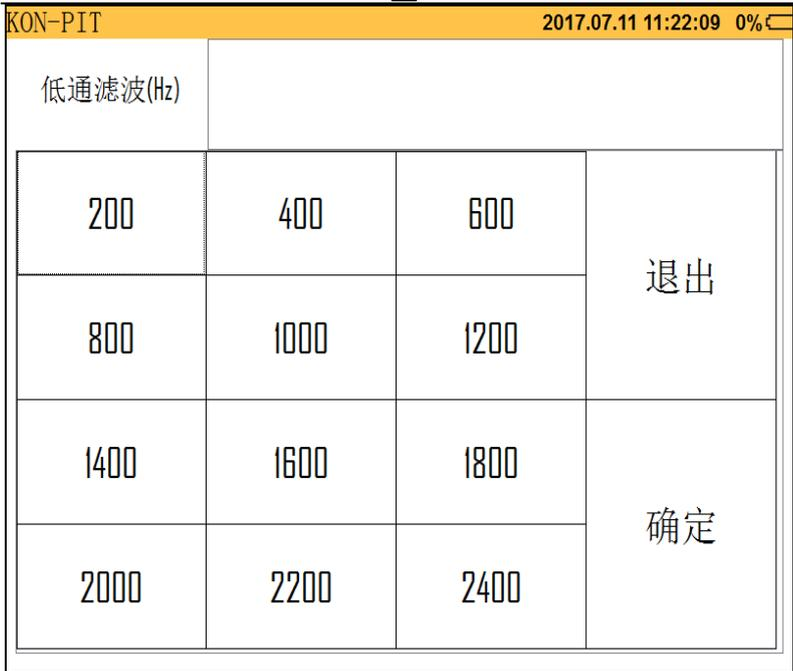
图 3-3-7 低通滤波输入界面
