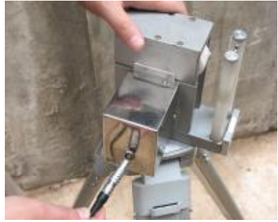
图 2.6 连接提升装置控制线
