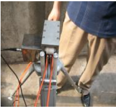
图 2.11 锁压信号线到提升装置上
