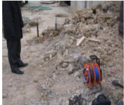
图 2.8 将探头下放到声测管
