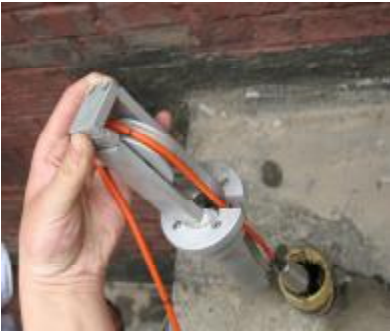
图 2.7 将探头下放到声测管
