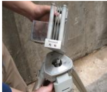
图 2.4 将提升装置固定在三脚架上
