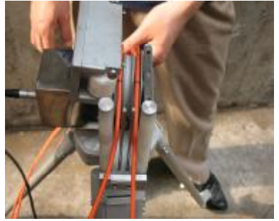
图 2.10 将信号线放在提升装置上
