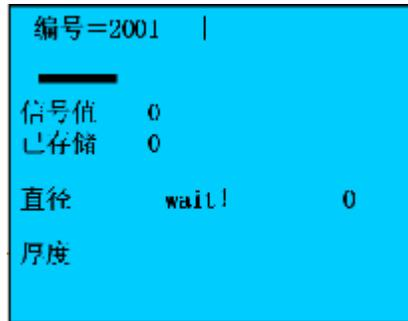
2. 先用探头准确确定钢筋的位置，然后把探头轴线与钢筋轴线重合，按“切换”键，仪器同时显示钢筋的直径和保护层厚度；
